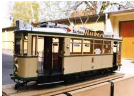
Hier sehen Sie das Modell des (baugleichen) Triebwagens 187. Um Ihnen einen Begriff von den Dimensionen des Modells zu geben: Länge 1,10 m; Höhe (mit Stromabnehmerbügel) 65 cm, Gewicht 23 kg. Übrigens: Das Modell ist fahrbereit! Bild: H. Eichner
