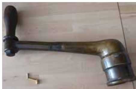
Die Handbremsen-Kurbel einer der alten Straßenbahnen. Das große Bild zeigt die Originalkurbel des Triebwagens 188, das kleine Bild die Miniatur im Maßstab 1 : 10. Auch hier ist wieder die Liebe zum Detail zu sehen, die Michael Tusch auszeichnet. Bild: H. Eichner
